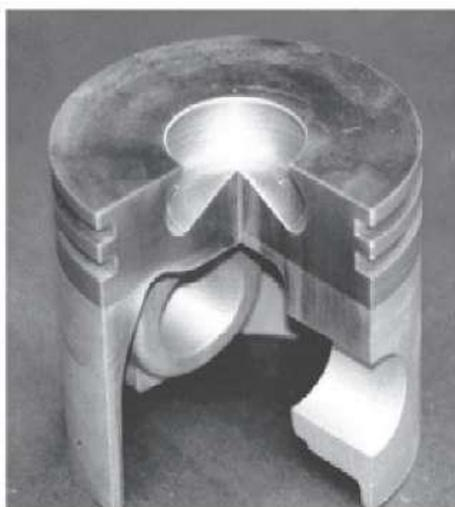
Рисунок 1 – Составной поршень из алюминия и стали
