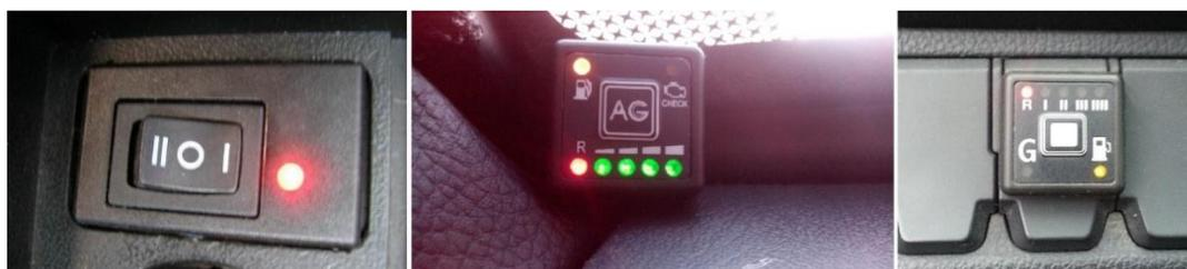
Рисунок 2- Варианты индикации кнопок переключения между газом и топливом
