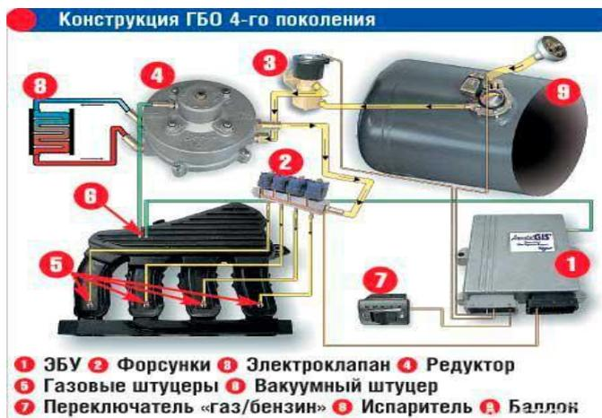
Рисунок 1- Конструкция ГБО четвертого поколения
