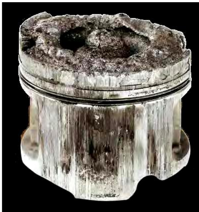
Рисунок 1 - Прогары и отложения на головке поршня (дизельный двигатель)
