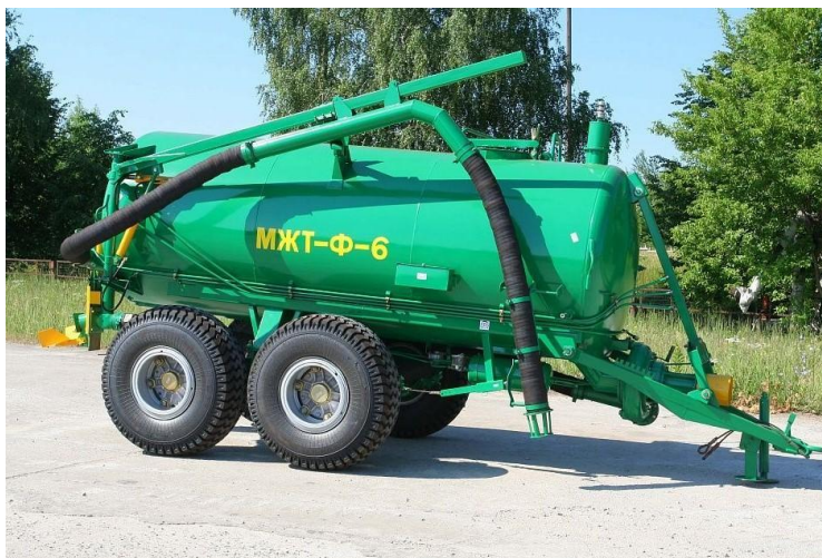
Рисунок 1.2 – Машина для внесения жидких органических удобрений МЖТ-Ф-6
