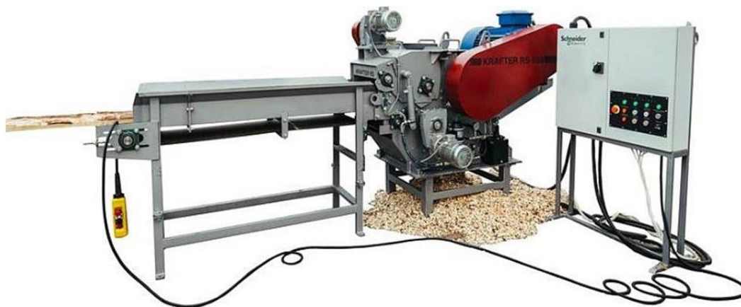
Рисунок 1 – Рубительная машина барабанного типа
