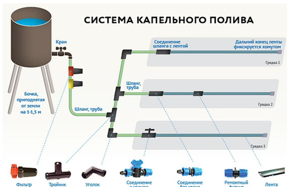
Рисунок 1.1 – Система капельного полива
