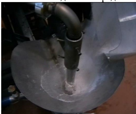
Рисунок 1 – Загрузка порошкообразного компонента в загрузочную камеру устройства ввода и смешивания
