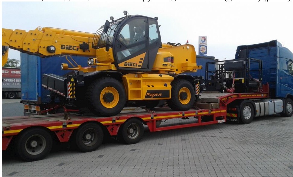
Рисунок 2 – Перевозка телескопического погрузчика на трале
