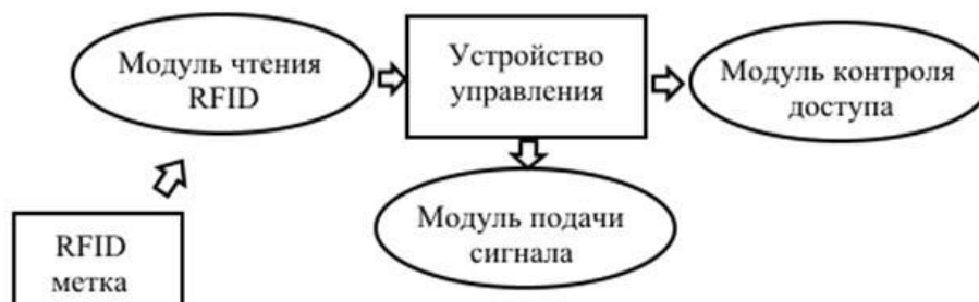
Рисунок 1 – Концепция взаимодействия метки с системой
