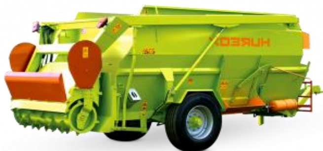
Рисунок 3- Кормораздатчик с горизонтальным расположением шнека и фрезой ИСРК-12Ф, ИСРК-15Ф
