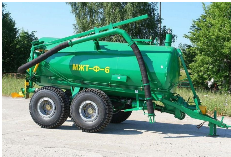
Рисунок 1.2 – Машина для внесения жидких органических удобрений МЖТ-Ф-6
