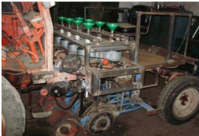
Рисунок 2 – Экспериментальный образец самоходной селекционной сеялки
