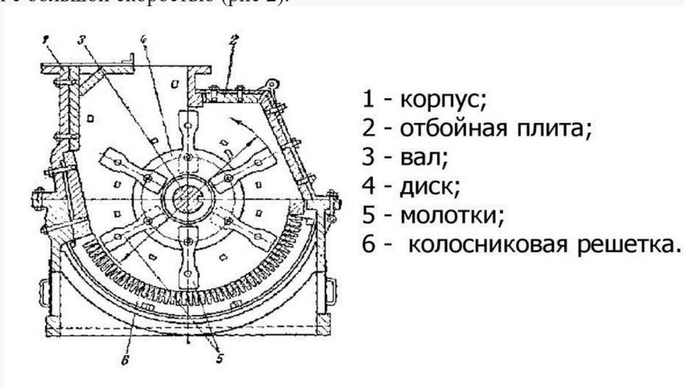
2. Рисунок 2 – Схема молотковой дробилки
