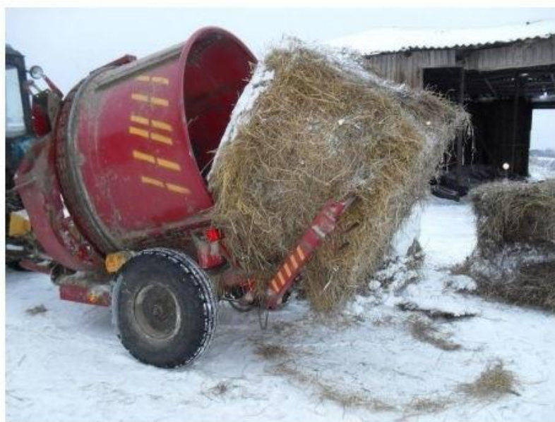
Рисунок 3 – Загрузка рулонов в измельчитель ИРК-145
