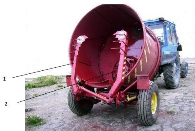
Рисунок 2 – Измельчитель рулонов грубых кормов ИРК-145 (сзади): 1 – манипулятор; 2 – ротор.
