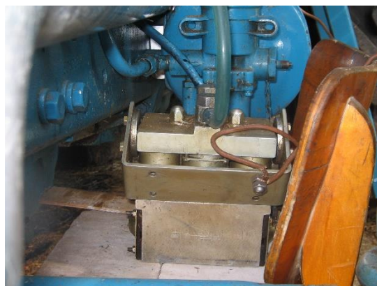
Рисунок 2 - Расходомер топлива ИП-179
