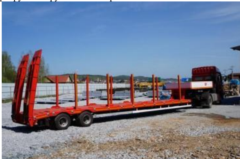
Рисунок 2 – Трал для длинномерной спецтехники
