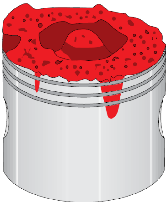
Рисунок 1 - Прогары и отложения на головке поршня (дизельный двигатель)
