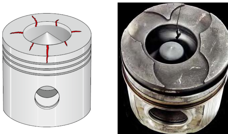
Рисунок 2 - Трещины в днище и в углублениях днища поршня
