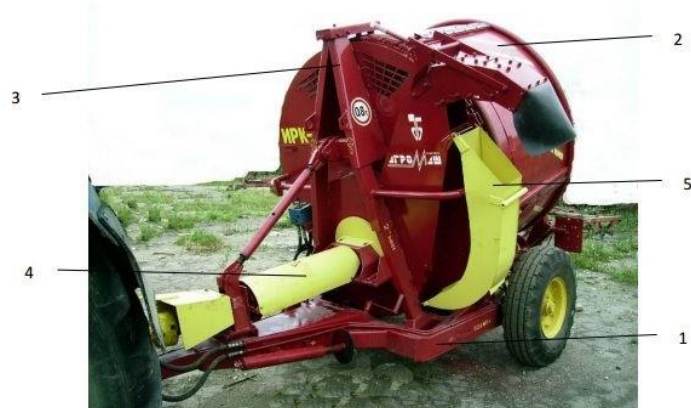
Рисунок 1 – Измельчитель грубых кормов в рулонах ИРК-145 (спереди): 1 – шасси; 2 – барабан; 3 – рама; 4 – трансмиссия, 5 – выгрузной рукав.
