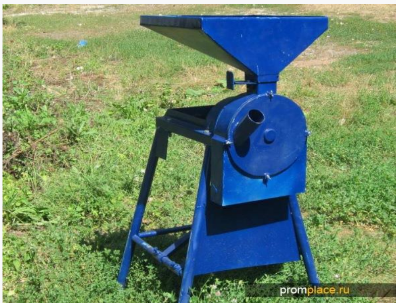
1. Рисунок 1 – Бытовая дробилка
