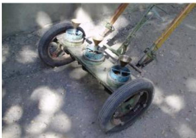
Рисунок 1 - Ручная трехрядная селекционная сеялка для мелкосемянных культур
