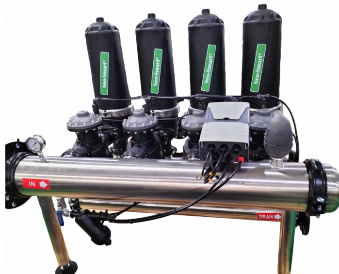
Рисунок 1.3 - Автоматические дисковые системы фильтрации NEO-SMART
