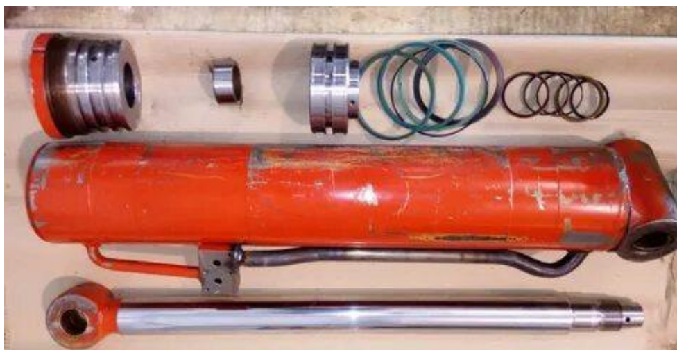
Рисунок 1 – Общий вид разобранного гидроцилиндра
