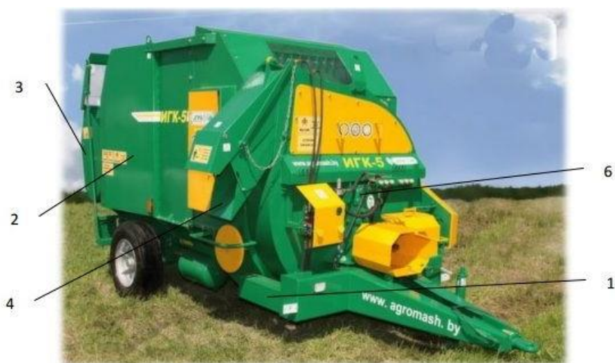
Рисунок 5 – Измельчитель рулонов грубых кормов ИГК-5: 1 – рама; 2 – бункер; 3 – лоток загрузочный; 4 – дефлектор; 6 – главный редуктор.
