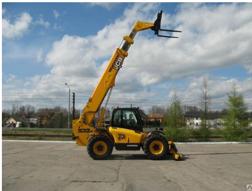
Рисунок 1 – Погрузчик телескопический JCB 532-120
