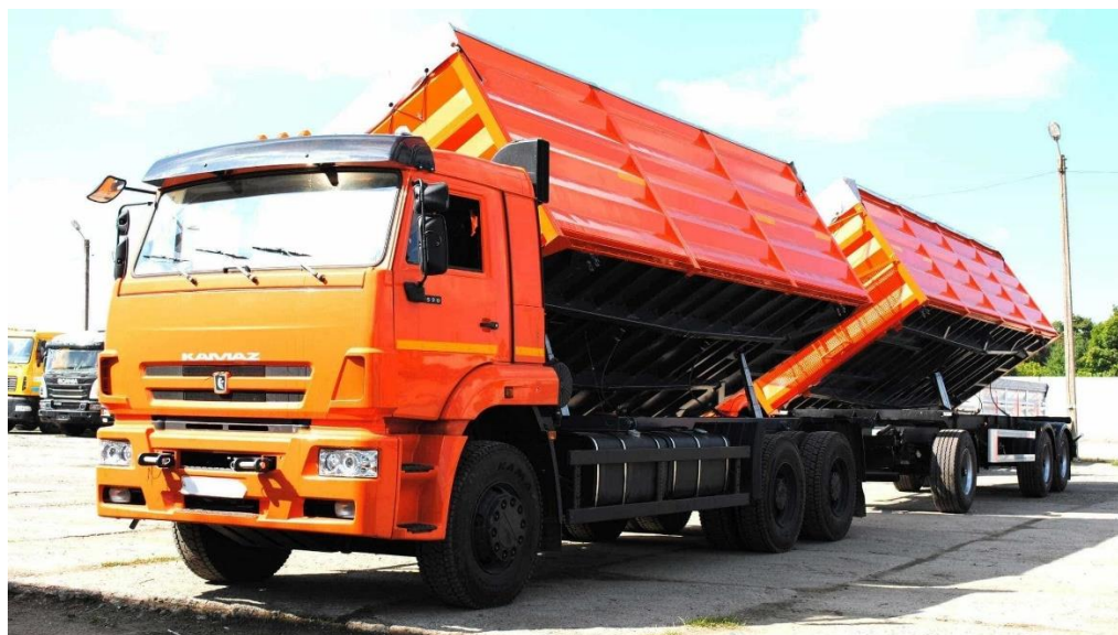
Рисунок 2 – Самосвал зерновоз КамАЗ-6520 с прицепом
