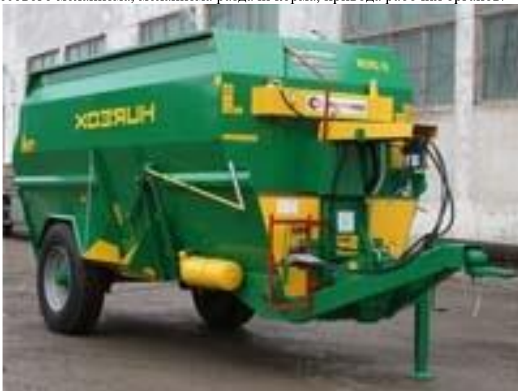
Рисунок 4 – Общий вид измельчителя – смесителя – раздатчика кормов ИСРК-12
