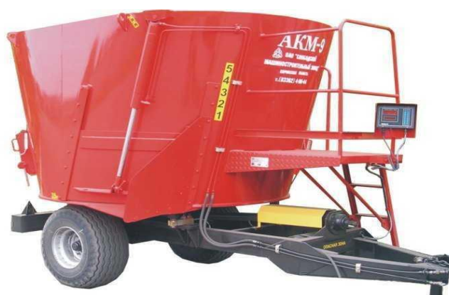
Рисунок 2 - Кормораздатчик АКМ-9 с вертикальным бункером
