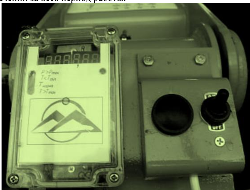
Рисунок 2 – Регистратор параметров для лесопромышленных гидроманипуляторов
