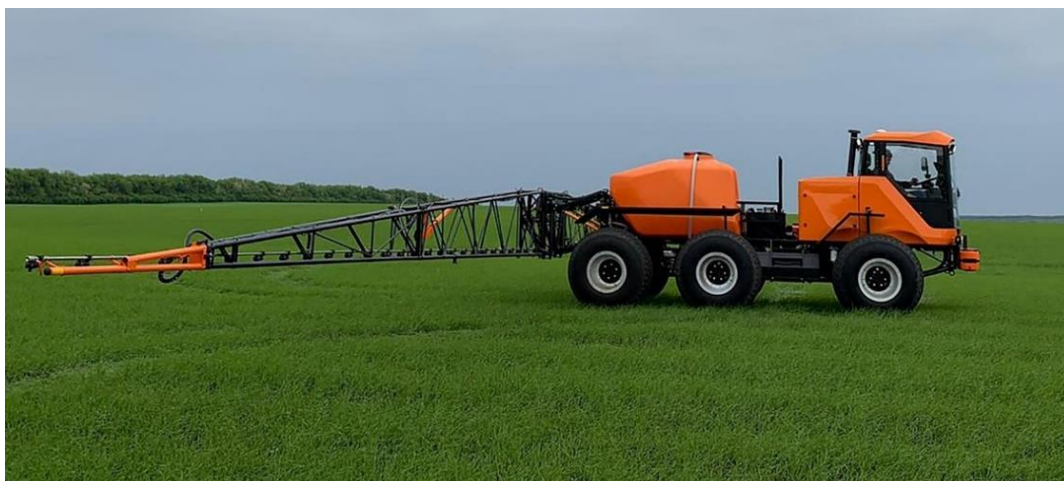
Рисунок 2 – Инновационный самоходный опрыскиватель «Туман-3» многофункционального технологического комплекса ООО «Пегас-Агро»
